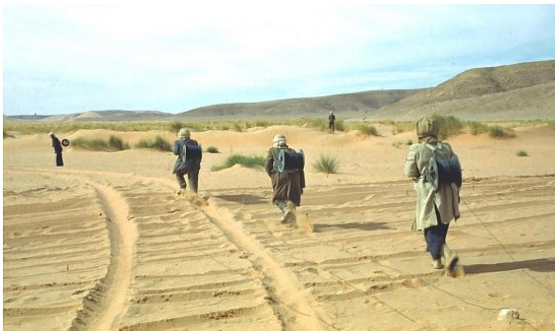
Les photos ci dessus montrent la mise en place d'un dispositif réfraction. Les géophones, des GS 13, étaient placés tous les trois cents mètres et reliés au laboratoire par du câble de tir déroulé, bien sur, à dos d'homme. ....Le léger fil se balançait au moindre zéphyr et dès que le vent se mettait à charrier du sable envoyait au labo des parasites interdisant l'enregistrement .Il fallait attendre, parfois plusieurs jour, l'accalmie afin de travailler correctement.
