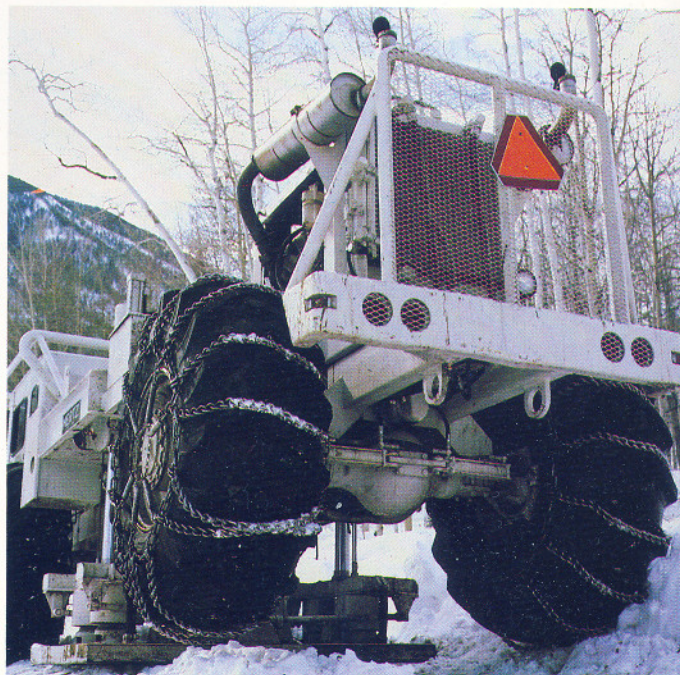
Vibreur en action (USA). Méthode Vibroseis. * Marque déposée Conoco.
