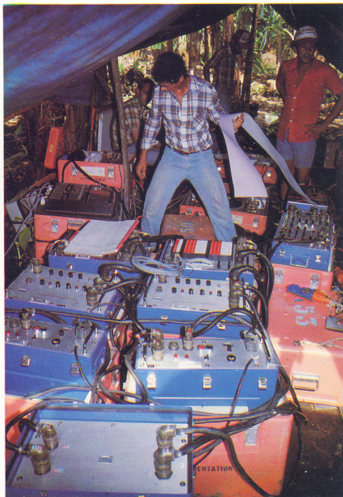
Laboratoire portable Sercel SN 338 B, 96 voies, 2 ms - Colombie.
