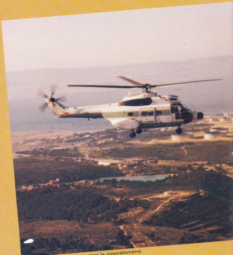
1978 - Hélicoptère Puma tractant le magnétomètre. A bord, chaîne d'acquisition Madacs et spectromètre.
